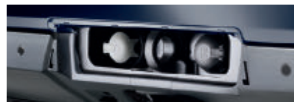
13-poliger Elektrosatz** (Abb. oben) Modelljahr 2010–2011 – VPLST0015 Ab Modelljahr 2012 – VPLST0071 Elektrosatz für kontinentaleuropäische Anhängersysteme. Zur Versorgung von Anhängerbeleuchtung und Zusatzverbrauchern in Wohnwagen.
