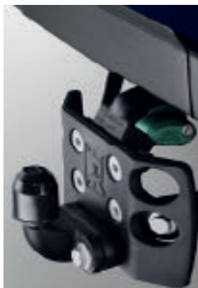
Höhenverstellbare Anhängerkupplung ‡ LR007484 Einstellbar auf drei verschiedene Kugelkopfhöhen. Niedrigste Kugelkopfposition 350 mm über dem Boden. Höchste Kugelkopfposition 450 mm über dem Boden. Zuglast 3500 kg (150 kg Stützlast). Erforderlich für private oder gewerbemässige Transporte von zwei- oder dreischigen Anhängern.
