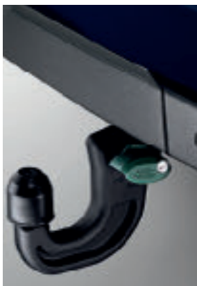
Abnehmbare Anhängerkupplung KNB500070 Einfacher Ein- und Ausbau. Abschliessbar. Kugelkopfhöhe 400 mm über dem Boden. Maximale Zuglast 3500 kg (Maximale Stützlast 150 kg). Nur für Freizeitzwecke erforderlich.
