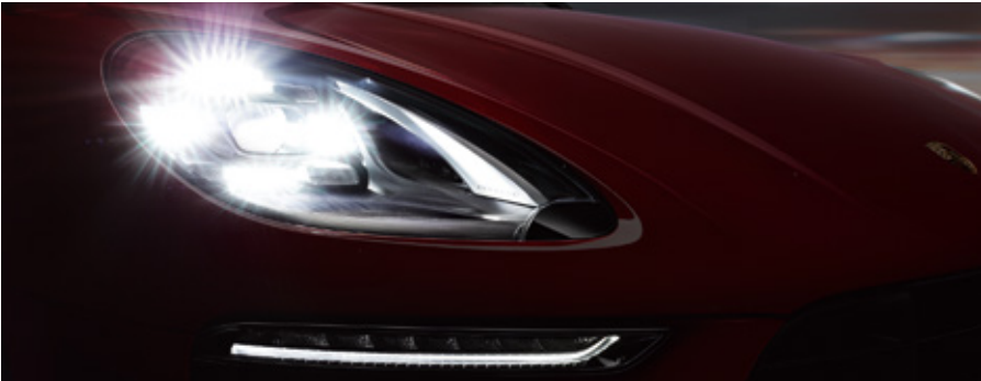
Fernlicht mit LED-Hauptscheinwerfer
