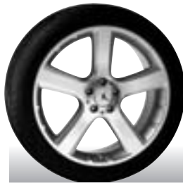
20 5-SPEICHEN-RAD 8,5 J x 20 ET 56 · 275/50 R20 B6 647 0129 Oberfläche titansilber oder Himalayas grey middle B6 647 0165
