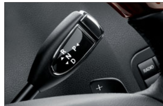
DIRECT SELECT-Lenkradschaltpaddles und -Wählhebel.
