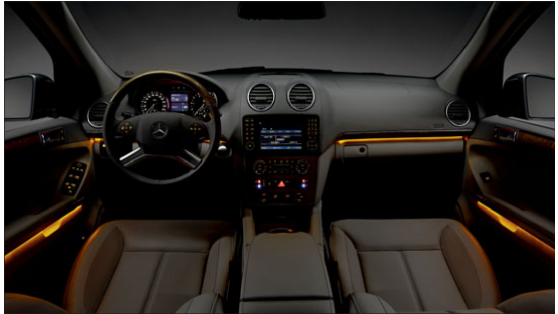
Die Ambientebeleuchtung leuchtet als schmales LED-Lichtband entlang der Holzzierleisten, der Instrumententafel und aller vier Türen. Über das Menü im Kombiinstrument sind fünf Helligkeitsstufen wählbar.
