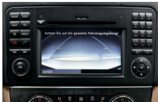
Die Rückfahrkamera nimmt das Umfeld des Heckbereichs auf.
