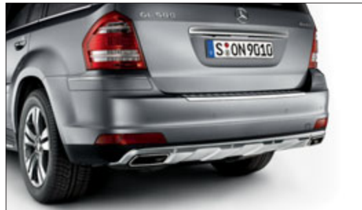
Das Heck wird mit optischem Unterschutz aus Edelstahl in Chromoptik aufgewertet.
