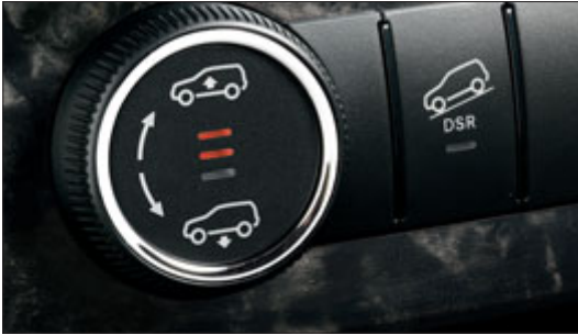
Das Fahrzeugniveau lässt sich mittels Drehrad anheben und absenken.
