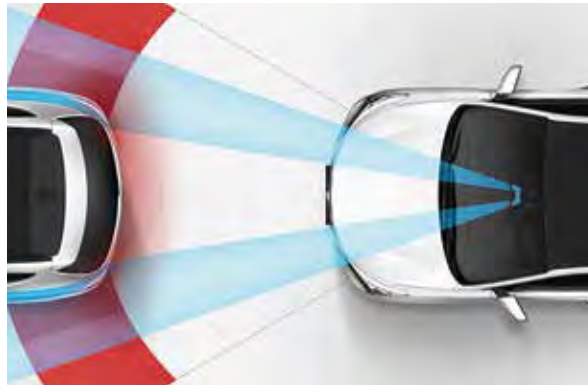
Autonomer Notbremsassistent 1 . Der durch Radar und Kamera gesteuerte Autonome Notbremsassistent warnt den Fahrer vor potenziellen Gefährdungen durch andere Fahrzeuge und Fußgänger. Er bremsst das Fahrzeug im Notfall automatisch ab.
