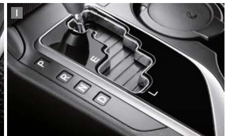
I. Fahrmodus Beim normalen Fahren sorgt der „E“-Modus für besondere Kraftstoffeffizienz. Der „L“-Modus ist speziell für langsames Fahren ausgelegt und ermöglicht es dem Motor, auf starke Verzögerung zu reagieren und wie ein konventionelles Fahrzeug zu bremsen.
