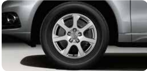
Aluminium-Schmiederäder im 7-Speichen-Design Größe 8 J x 17 mit Reifen 235/65 R 17 1
