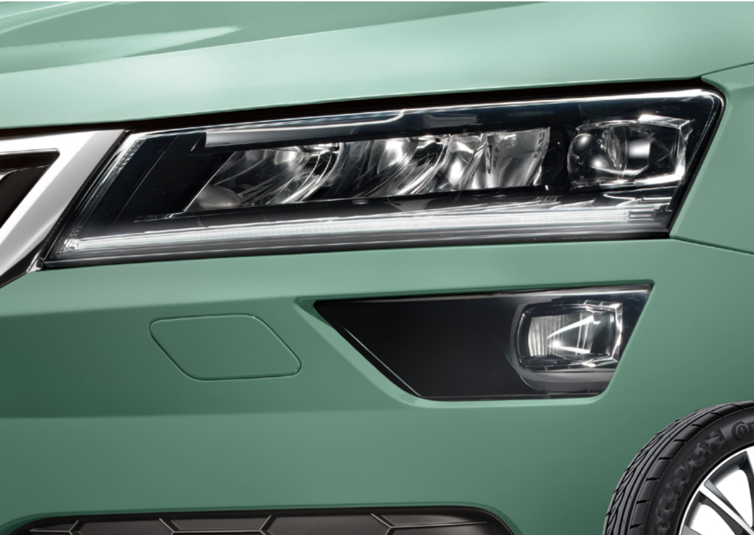
HALOGENSCHEINWERFER Dank der serienmäßigen Halogenscheinwerfer wird die Straße optimal ausgeleuchtet. Mit den optionalen LED-Scheinwerfern (links im Bild) verleihen Sie Ihrem SCOUT zusätzliche Präsenz im Gelände wie auf der Straße. Dazu sorgt die Scheinwerferreinigungsanlage für saubere Scheinwerfer und damit für bessere Sichtverhältnisse.
