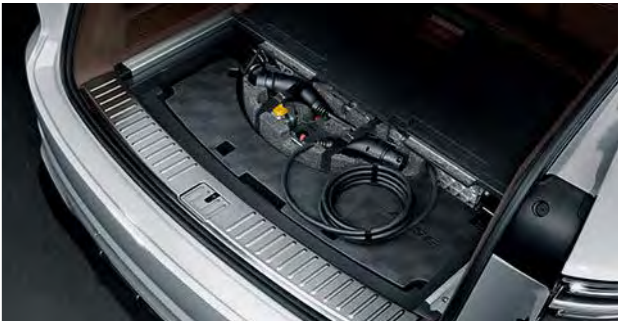
Ladekabel für das Laden an öffentlichen Ladesäulen (Kabel vorspiralisiert, im Kofferraumunterboden)
