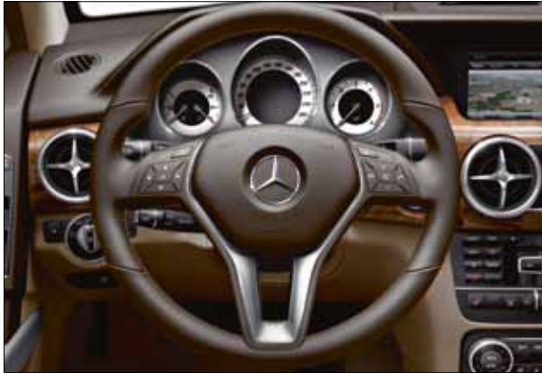
Komfort-Multifunktionslenkrad mit 12 Tasten und 11,4-cm-Farbdisplay im Kombiinstrument.
