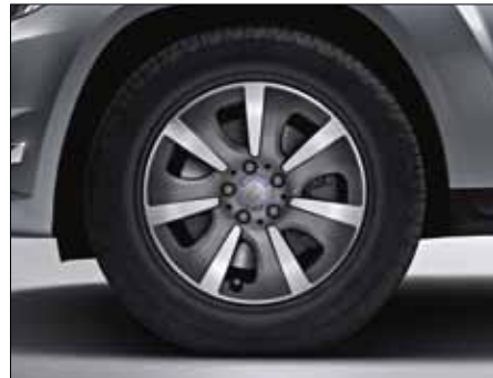
Leichtmetallrad im 7-Speichen-Design, titangrau lackiert und glanzgedreht, mit Bereifung 235/60 R 17 (optional, Code 19R).
