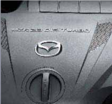
2.3i DISI Turbomotor (mit direkter Benzineinspritzung)
