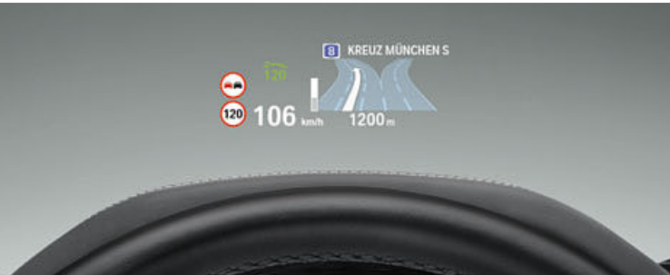
□ Das vollfarbige BMW Head-Up Display⁴ blendet per optischer Projektion für die Fahrt relevante Daten in das Sichtfeld des Fahrers ein und steigert damit die Konzentration auf das Fahrgeschehen. Unter anderem werden die aktuelle Geschwindigkeit, Navigationshinweise, die Speed Limit Info inkl. Überholverbotsanzeige und Telefon- und Entertainmentlisten angezeigt.
