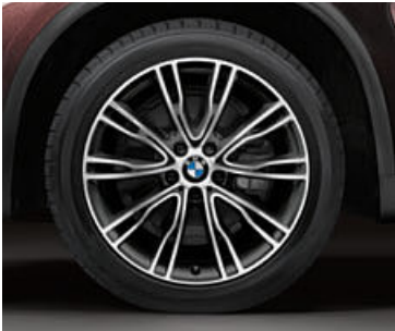
□ 20" BMW Individual Leichtmetallräder V-Speiche 551 I mit Mischbereifung, Größe vorn 10 J x 20, Bereifung 275/40 R 20, Größe hinten 11 J x 20, Bereifung 315/35 R 20.
