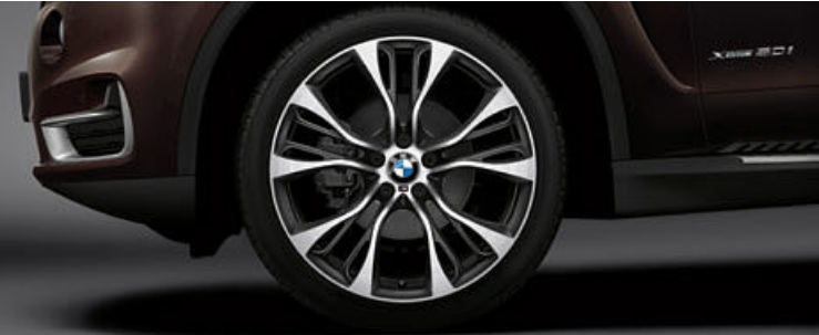
□ 21" M Leichtmetallräder Doppelspeiche 599 M in Bicolor Orbitgrau matt, sichtbar glanzgedreht, mit Mischbereifung und Notlaufeigenschaften, Größe vorn 10J x 21, Bereifung 285/35 R21, Größe hinten 11,5J x 21, Bereifung 325/30 R21.
