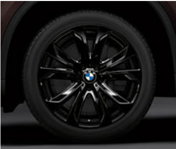
□ 20" Leichtmetallräder Sternspeiche 491 mit Mischbereifung, Schwarz hochglänzend, Größe vorn 10 J x 20, Bereifung 275/40 R 20, Größe hinten 11 J x 20, Bereifung 315/35 R 20.
