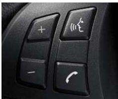
□ Spracheingabesystem: Damit lassen sich während der Fahrt z. B. Radiosender, Navigationsziele oder Telefonanrufe steuern, die gleichzeitig im Control Display angezeigt werden (diese Funktion ist im Umfang Navigationssystem Professional enthalten).
