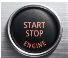
■ Start-/Stop-Knopf zum Starten des Motors. Nach Einstecken des Zündschlüssels können Sie den Motor per Knopfdruck starten bzw. wieder stoppen.
