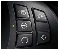
□ Lenkradheizung: Auf Knopfdruck lässt sich der Lenkradkranz in kurzer Zeit erwärmen – besonders angenehm im Winter.
