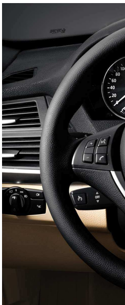
□ Sport-Lederlenkrad , inkl. Multifunktion □ Aktivlenkung passt die Lenkübersetzung für höchste Lenkpräzision, Agilität und Komfort.
