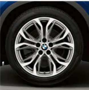
□ 19" Leichtmetallräder Y-Speiche 511, Orbitgrau, glanzgedreht, mit Notlauf-eigenschaften, Radgröße 8J x 19, Bereifung 225/45 R19.
