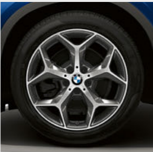
□ 18" Leichtmetallräder Y-Speiche 566, Ferricgrau, glanzgedreht, Radgröße 7,5J x 18, Bereifung 225/50 R18.
