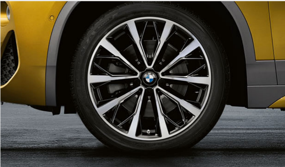
○ Die hochwertigen 19" Leichtmetallräder V-Speiche 573 sind in Bicolor Schwarz, sichtsseitig glanzgedreht und gewichtsoptimiert ausgeführt. Sommer-Komplettetradsatz mit Runflat-Bereifung, Radgröße 8J x 19 mit Reifengröße 225/45 R19 92W RSC.
